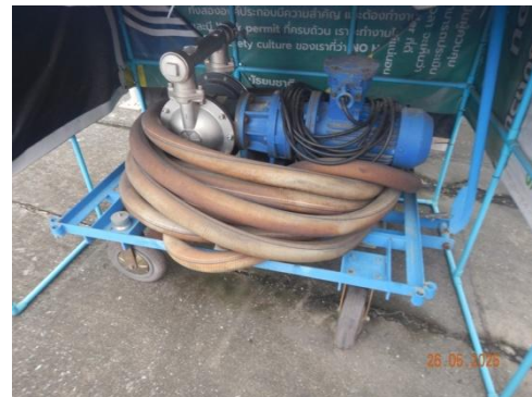
ปั๊มของเหลว (Diaphragm Pump) สำหรับสูบน้ำสารเคมีที่รั่วไหลลงถึง
