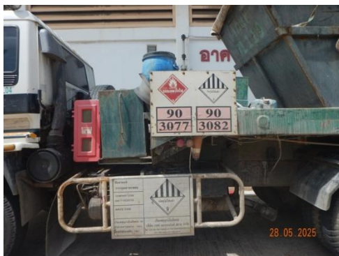
รูปที่ 3-31 การติดหมายเลขโทรศัพท์ไว้ข้างรถขนส่งกากของเสียอันตราย
