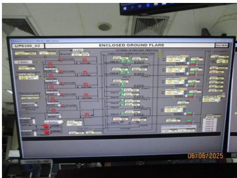
รูปที่ 3-9 ระบบ DCS ของหอเผาทั้งระดับพื้นดินแบบมิดชิด (Enclosed Ground Flare Pilot)
