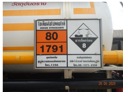
รูปที่ 3-26 ป้ายชื่อและหมายเลขโทรศัพท์ติดต่อกรณีฉุกเฉินบนรถขนส่งสารเคมีและผลิตภัณฑ์
