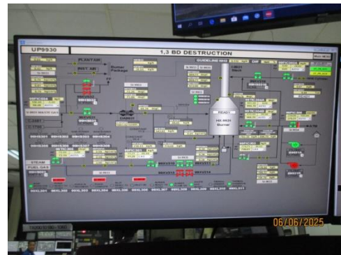
รูปที่ 3-4 ระบบ DCS ของหน่วยกำจัด 1,3-Butadiene
