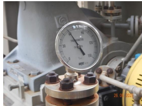
รูปที่ 3-73 อุปกรณ์วัดอุณหภูมิ (Temperature Indicator) ในพื้นที่กระบวนการผลิต
